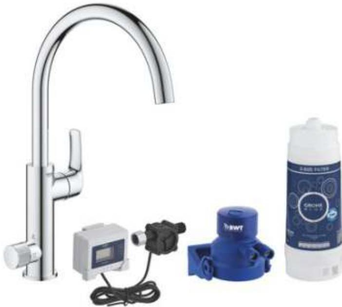
°Sistema GROHE BLUE grazie al funzionamento a 5 fasi, oltre a migliorare l'odore e il sapore dell'acqua rimuovendo il cloro ed eventuali sostanze nocive presenti nell'acqua di rete, riduce la durezza, diminuisce il residuo fisso e rimuove alcuni metalli pesanti come ferro, rame, piombo, nichel, zinco, cadmio
